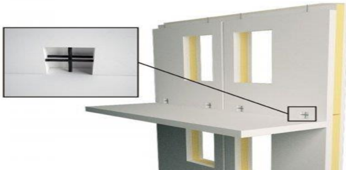
Рисунок 2. Процесс монтажа панелей на посадочные места, горизонтальная стыковка Для гарантированного утепления при монтаже в горизонтальные и вертикальные швы прокладывается лента из утеплителя. Разработана технология производства монтажных работ в зимних условиях при температуре до -20^{\circ}\text{C} . Таким образом, отсутствие сварочных работ на строительной площадке, точность геометрии изделий и положения закладных деталей позволяют обеспечить высокую скорость и технологичность монтажа. (Монтажное звено состоит из 4-х квалифицированных рабочих). Наша технология монтажа гарантирует потребителю высокопрочное и долговечное жилье с высокой теплоизоляцией.
