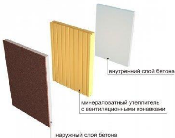
Рисунок 7: Минеральный утеплитель с вентиляционными канавками. Канавки размещаются вертикально и горизонтально.
