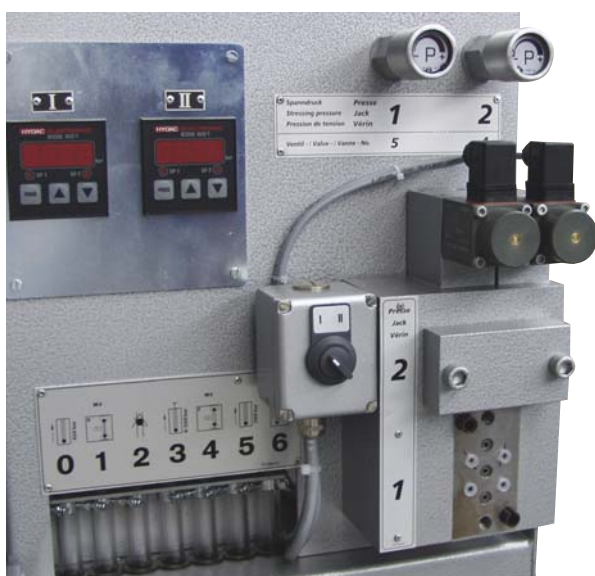
Двойное подключение (с электрическим переключением от одного соединения к другому)
