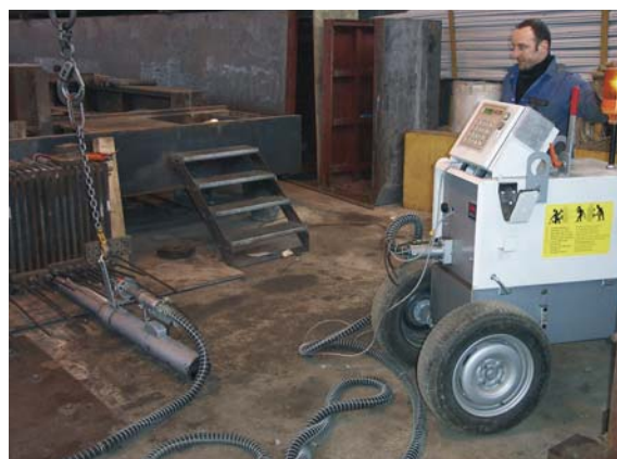
Применение домкрата с усилием 300 кН и ходом 400 мм для пряди диаметром 0,6 дюйма с использованием блока TENSACONTROL для натяжения мостовых балок
