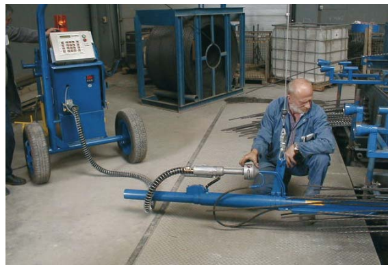
Применение домкрата с усилием 160 кН и ходом 500 мм для пряди диаметром 1/2 дюйма с использованием блока TENSACONTROL для натяжения стропильных ферм
