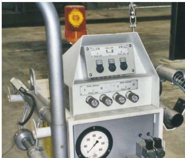
Специальный блок управления для предварительной установки значений давления натяжения
